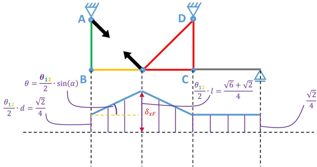
Il ne reste plus qu'à retracer les diagrammes mais maintenant en reprenant les traverses et les longerons :
