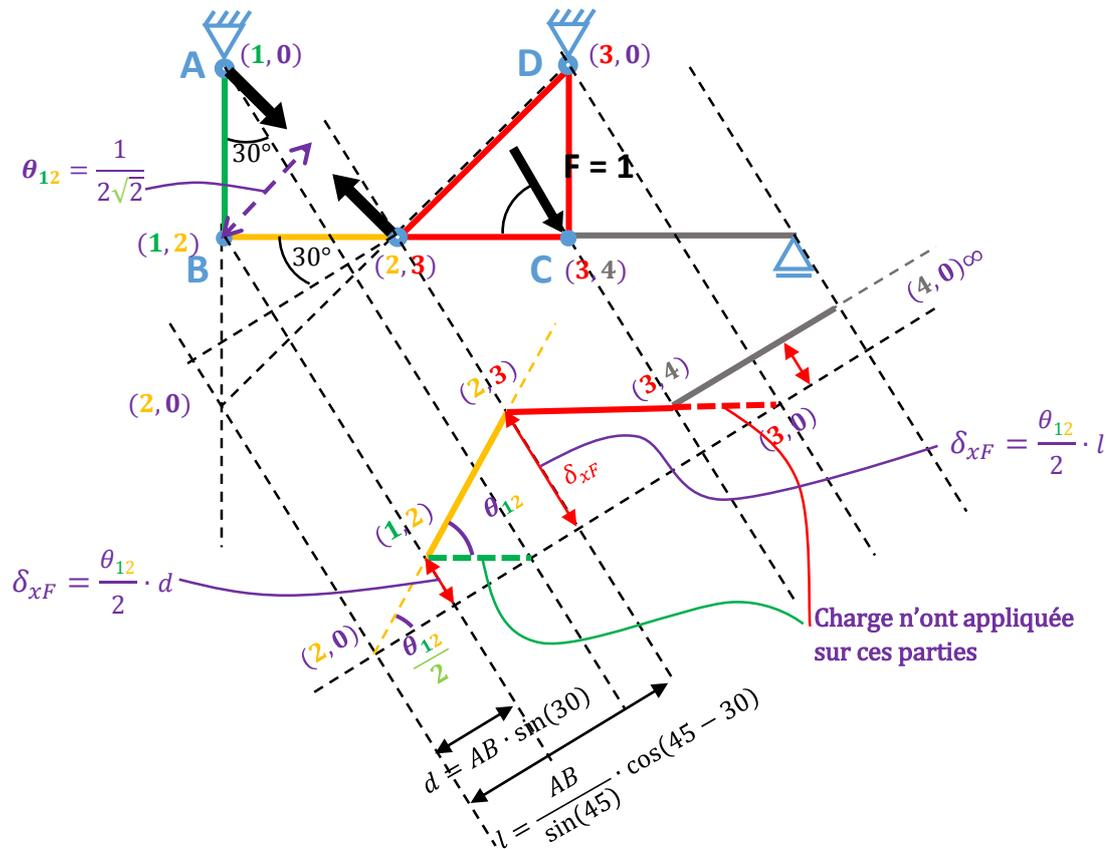
On passe maintenant aux déplacements suivant la ligne d'action de F :
